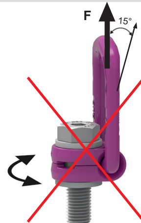
Fig. 7: Forbudt dreieretning ved belastning i aksial retning
