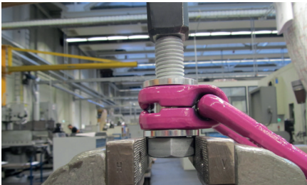
Fig. 8: Feste av VLBG-PLUS for å demontere skruen
